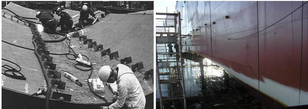
Slika br. 17. Šavovi i stikovi oplate.<sup>25</sup> Slika br. 18. Šavovi vanjske oplate.<sup>26</sup>
