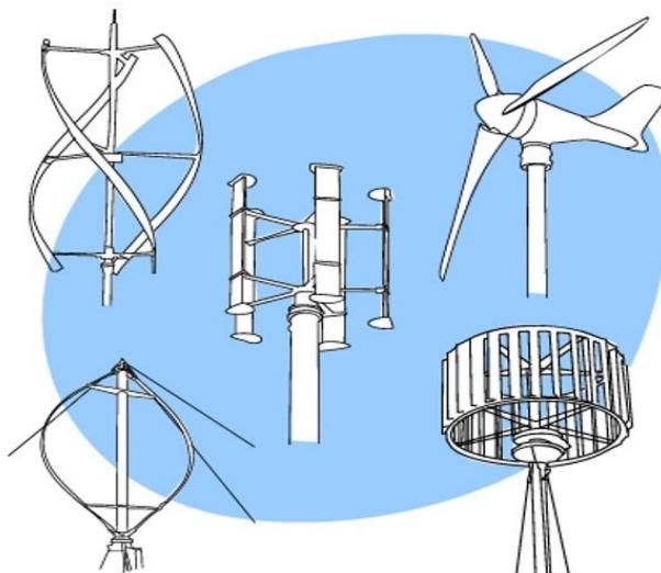
Slika 10. Konstrukcijski tipovi vjetrogeneratora obzirom na položaj osovina rotora.<sup>25</sup>
