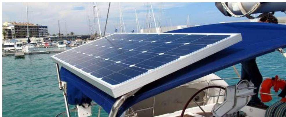
Slika 15. Monokristalni solarni paneli.<sup>29</sup>
