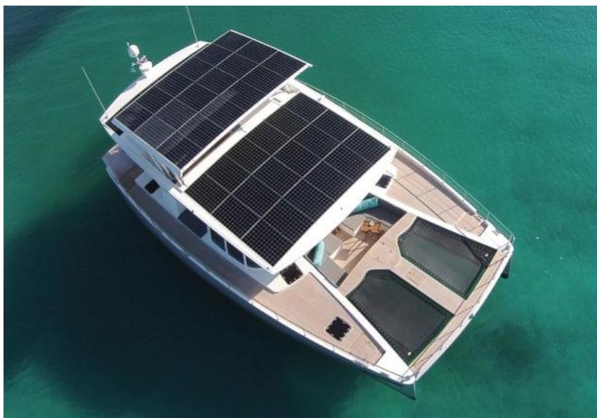
Slika 16. Polikristalni solarni paneli.<sup>30</sup>
