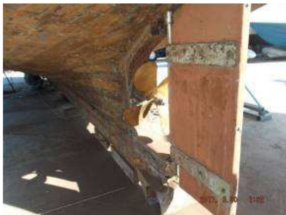
Slika 18. Pregled lista kormila i osovinskog voda sa propelom. 63
