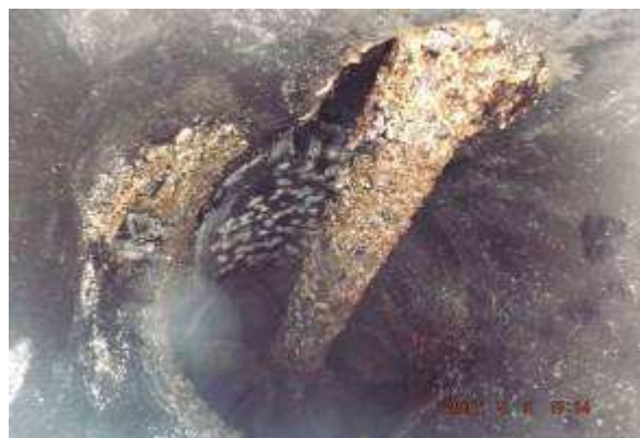
Slika 32. Naslage u tunelu i vratilu džeta. 77
