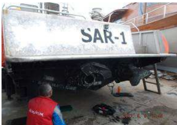
Slika 31. Čišćenje spoljnih jedinica džetova. 76
