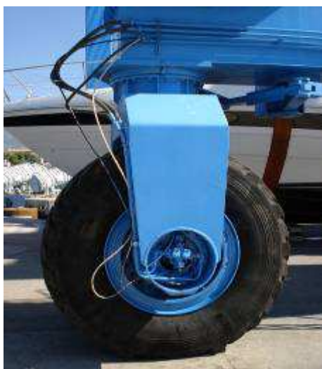
Slika 9. Hidrocilindar za radijalno okretanje točka. 54
