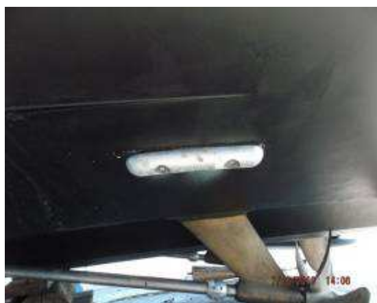
Slika 52. Novi cink protektor na trupu Jahte. 97
