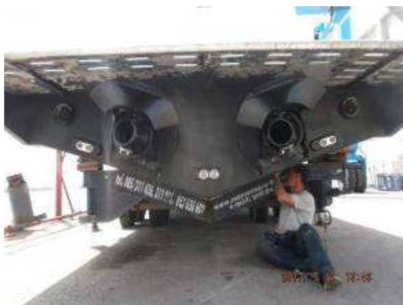
Slika 38. Montaža anoda na trupu i spoljnim jedinicama džetova. 83
