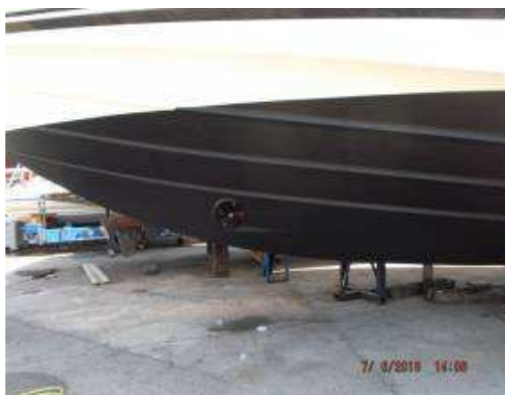
Slika 50. Bowtruster servisiran i nanijet antivegetativni premaz. 95
