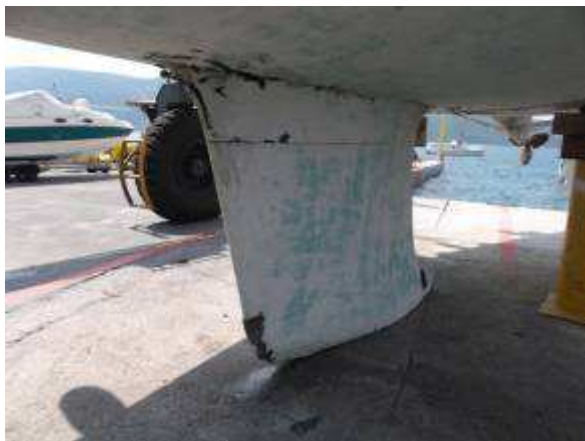
Slika 41. Udar balastne kobilice u podvodnu hrid. 86
